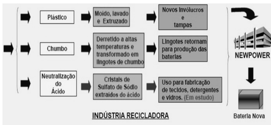
Figura 4 – Processos de reciclagem das baterias Fonte: Newpower (2013)
