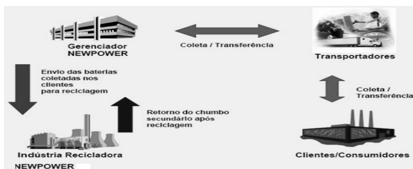
Figura 3 –Fluxo de retorno e destino de baterias em assistência técnica Fonte: Newpower (2013)
